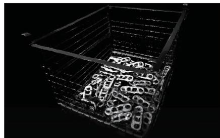
▲ 散乱放置的工件（链轨节）
