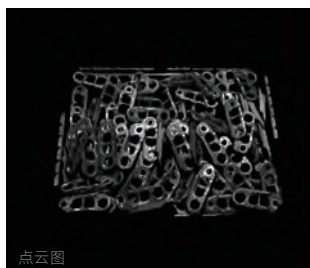
散落放置的工件（链轨节）
