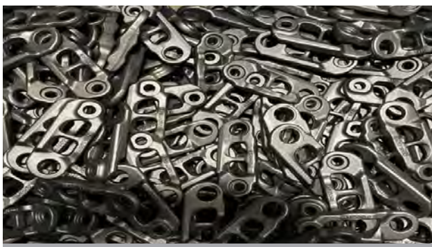
(工件堆叠严重、厂房内典型环境光干扰严重、料框较深)
