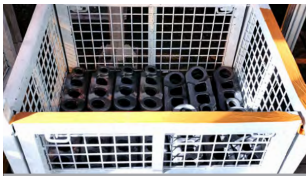
(工件堆叠严重、厂房内典型环境光干扰严重、料框较深)
