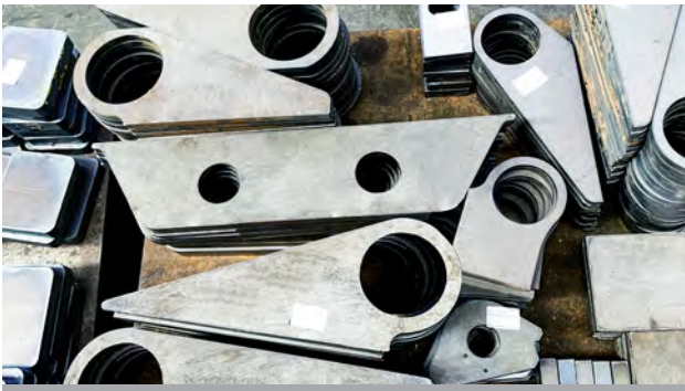
开坡口钢板规格繁多
