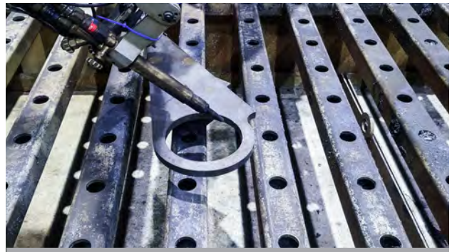
开坡口切割实际现场
