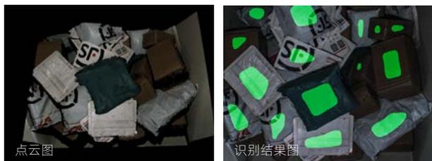
随意堆叠的真实快递包裹(红色部分表示检测到被压叠物体)
