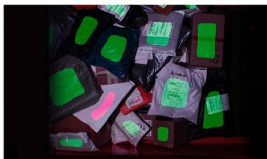
识别结果图（红色部分表示检测到被压叠物体）
