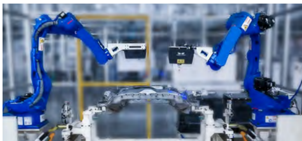
某大型汽车主机厂 副车架在线测量
