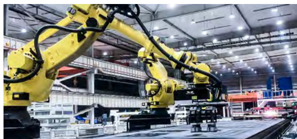
某工程机械巨头 视觉引导钢板切割下料
