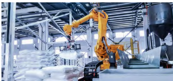
某大型化工厂 视觉引导麻袋拆垛破包
