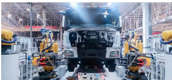
某大型汽车主机厂 视觉引导重汽轮胎随行装配
