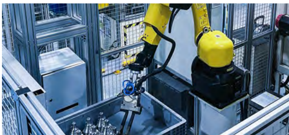
某大型汽车零配件厂 视觉引导外星轮抓取上料
