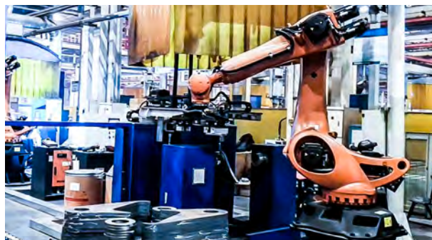
某大型工程机械厂 视觉引导拉杆 & 耳板组对焊接上料
