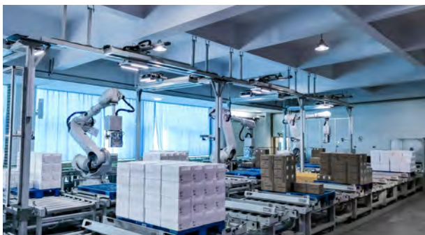
某大型制造工厂 视觉引导纸箱 / 泡沫箱拆垛
