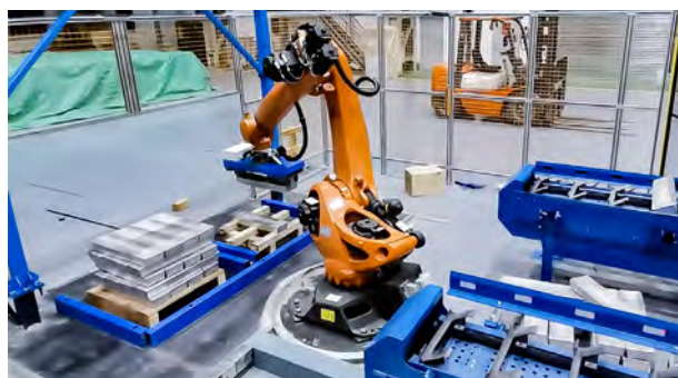
某大型汽配厂 视觉引导镁锭拆垛
