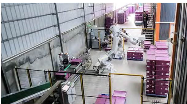
某大型玩具制造商 视觉引导周转箱拆码垛
