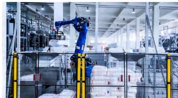
某大型光伏原材料厂 视觉引导麻袋拆垛破包
