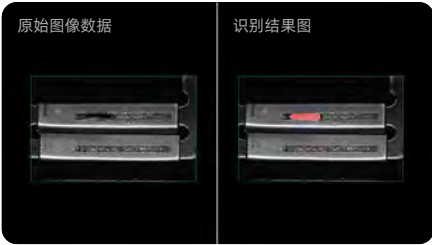
外观缺陷检测 像素级识别产品外观缺陷，实时管控产品质量。
