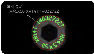
字符检测 & 识别 (OCR) 可准确定位、识别图像中的字符，有效应对图像背景复杂、字符位置随机等情况。
