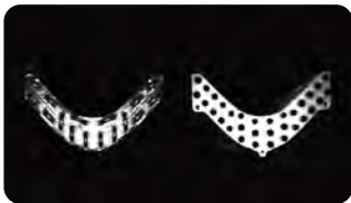
图像分类 可区分工件正反面、朝向、缺陷种类，判断物体是否缺失、排列是否整齐。
