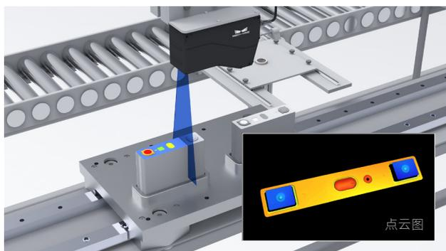
锂电池电芯平面度 / 段差测量
