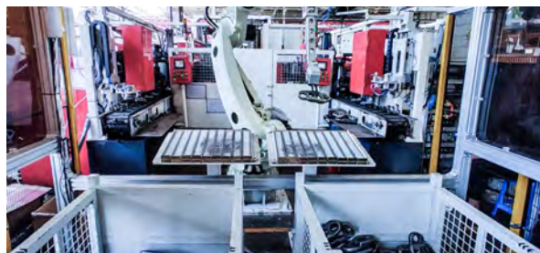
某工程机械巨头 视觉引导链轨节深筐抓取上料
