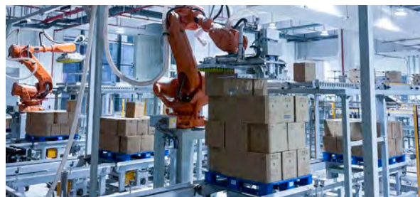
某大型酒厂 视觉引导纸箱拆垛
