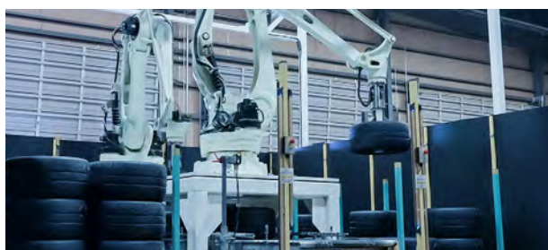
某大型轮胎仓库 视觉引导轮胎抓取
