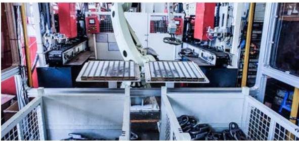
某大型工程机械厂 视觉引导链轨节深筐抓取上料
