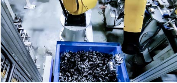
某大型汽车零部件厂 视觉引导内星轮抓取上料
