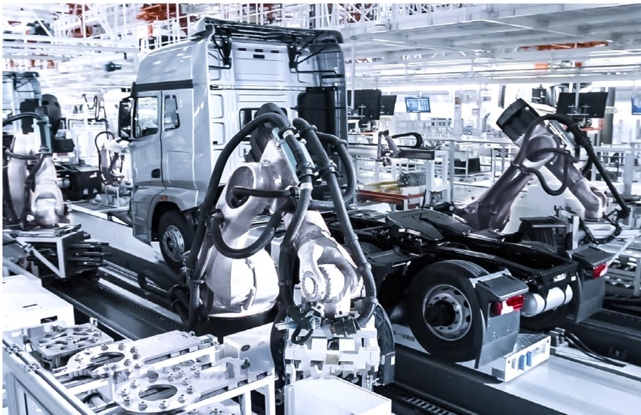
汽车主机厂总装车间是汽车制造进程中最后一个阶段，负责将各个分总成和零部件组装成一辆完整的汽车。总装车间工艺流程复杂、生产环境高度集成，更多主机厂也开始引入先进技术保证汽车高质量、高效率生产，以满足不断变化的市场需求。目前，已有多家汽车主机厂总装车间引入梅卡曼德 3D 视觉进行生产，已稳定投产的应用包括轮胎随行安装、车门密封胶辊压、座椅投放、Vin 码打刻、螺栓拧紧、仪表台安装等。
