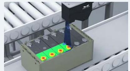
锂电池模组 busbar 焊缝检测
