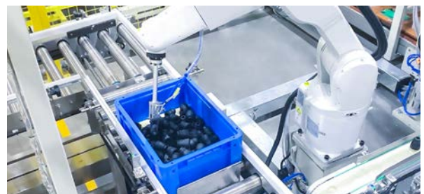
某国内头部空调厂 视觉引导空调脚垫上料
