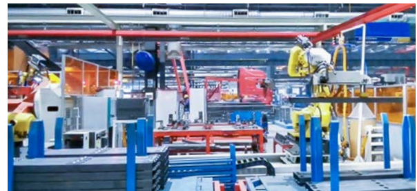
某大型工程机械厂 视觉引导方管组对焊接上料
