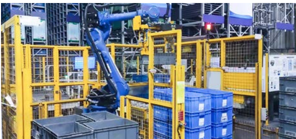
某大型汽配厂 视觉引导周转箱拆垛
