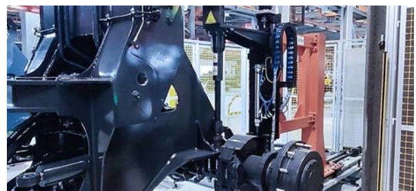
某大型工程机械厂 视觉引导高精度螺栓拧紧
