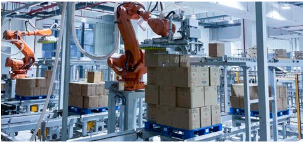
某大型酒厂 视觉引导纸箱拆垛
