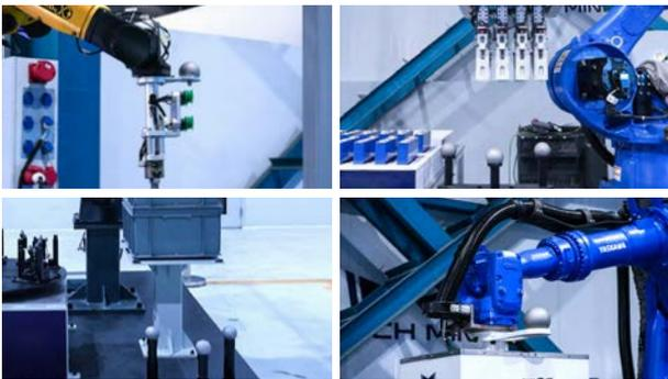
多种标定球安装方式：针对 EIH\ETH 等不同相机安装方式、较大夹具或空间受限等场景，可提供对应的安装方案。
