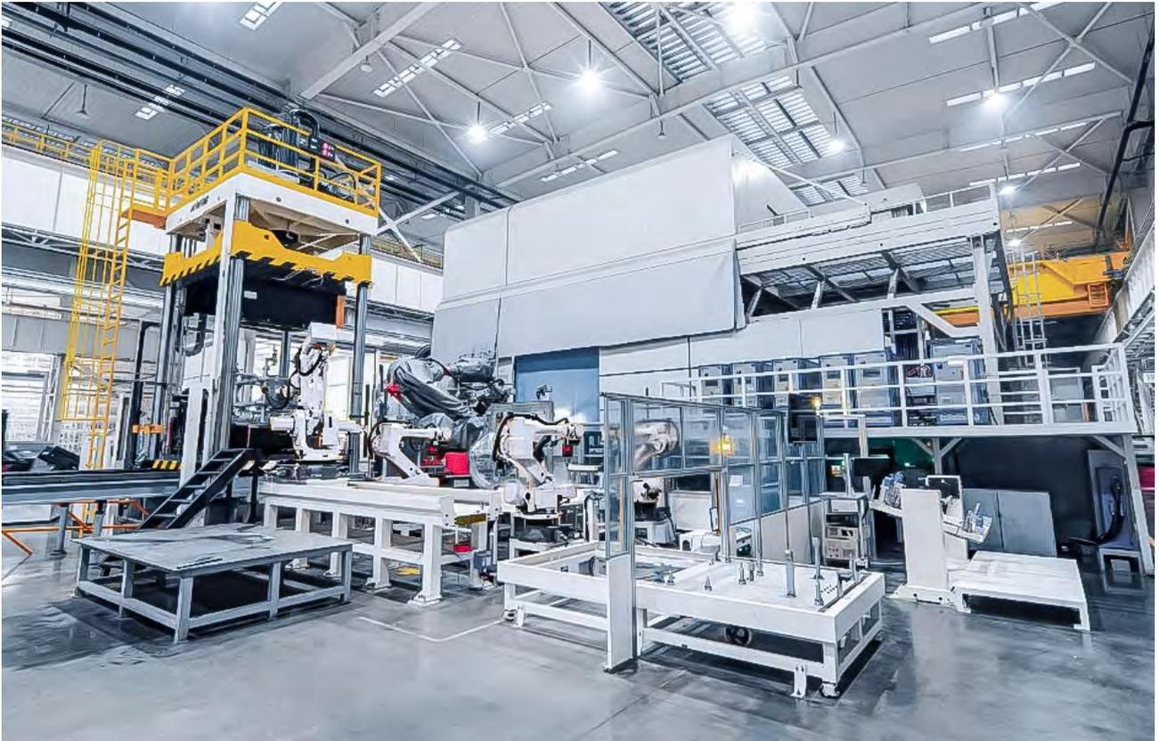
一体化压铸能够快速成型许多汽车分总成，如前机舱、前后底板等，这些工件体积大、自重大，对这些工件进行转运也催生了许多自动化需求。许多车厂开始引入先进制造技术对一体化压铸车间进行改造，而 AI+3D 视觉技术能够满足车厂对于精度、柔性化等多方面的需求，提升压铸车间大型工件自动化转运水平。
