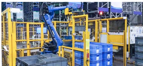
某大型汽配厂 视觉引导周转箱拆垛
