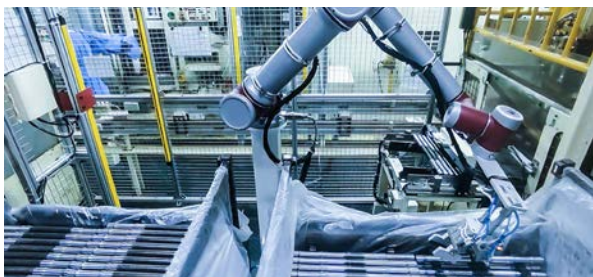
某大型汽车零部件厂 视觉引导中间轴抓取上料
