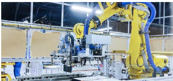
某大型汽车主机厂 视觉引导电池模组上料
