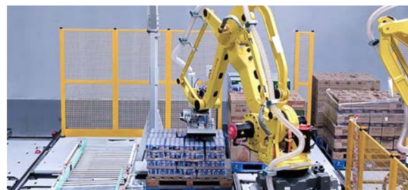
某大型物流公司 视觉引导透明膜包拆垛
