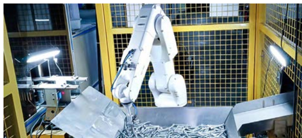
某大型金属加工厂 视觉引导螺钉抓取上料
