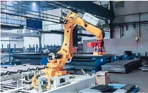
某大型工程机械厂 3D 视觉引导钢板校平上料
