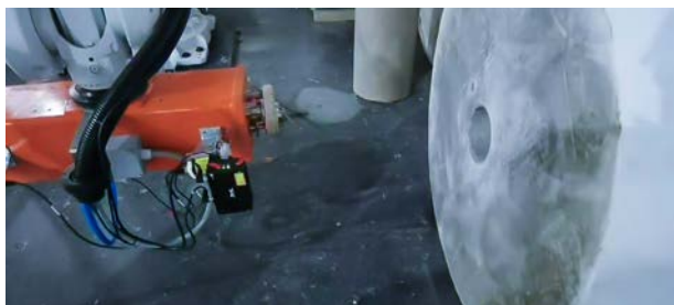
某大型造纸厂 视觉引导纸芯塞装配
