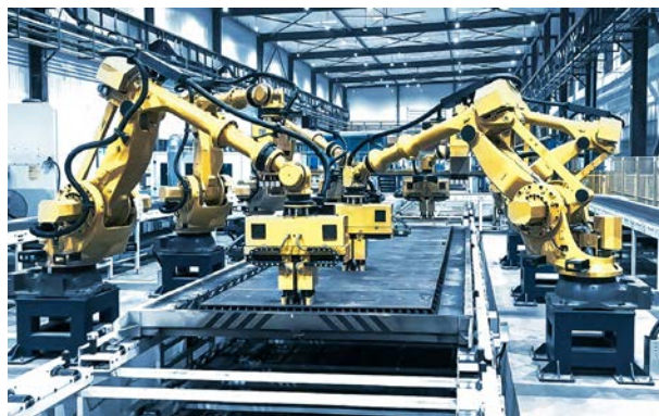
某大型工程机械厂 3D 视觉引导钢板分拣
