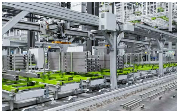
某大型工程机械厂 3D 视觉引导剪叉车叉臂高精度配盘
