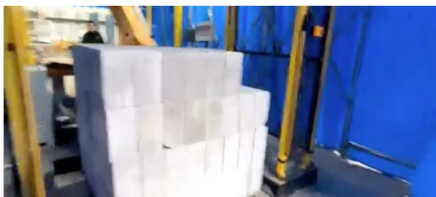
某大型建筑工厂 视觉引导砖块拆垛
