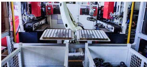
某大型工程机械厂 视觉引导链轨节深筐抓取上料
