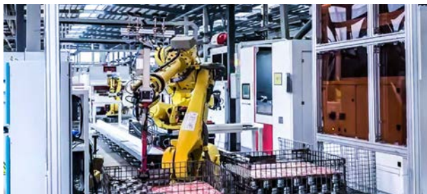
某大型工程机械厂 视觉引导半轮体抓取上料
