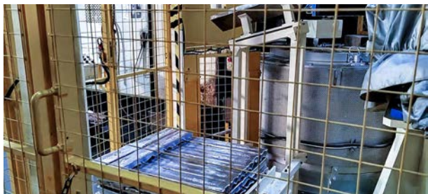
某大型工程机械企业厂 视觉引导铝锭拆垛
