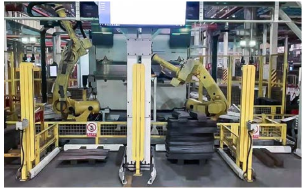
某大型工程机械厂 3D 视觉引导钢板折弯上料 & 型号识别
