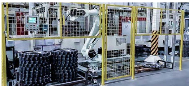
某大型工程机械厂 视觉引导驱动轮抓取上料
