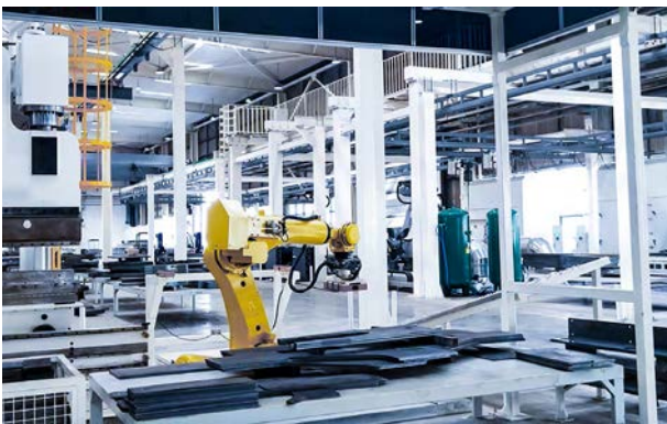
某大型工程机械厂 3D 视觉引导钢板折弯上料
