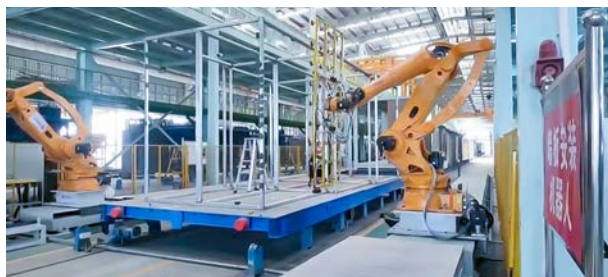
某大型建筑工厂 视觉引导门板装配
