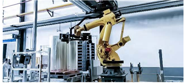
某大型塑料厂 视觉引导薄膜卷上料 & 尺寸识别
