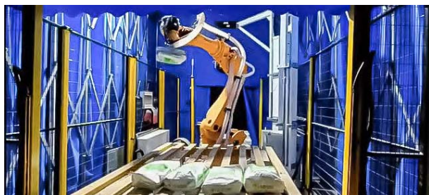
某大型建筑工厂 视觉引导袋装腻子粉码垛
