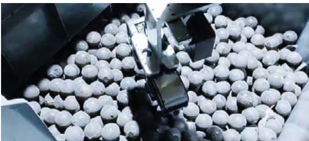
某大型钢铁厂 视觉引导研磨球抓取上料
