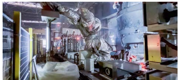
某大型钢铁厂 视觉引导覆盖剂抓取上料
