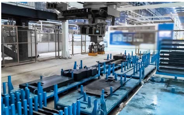
某大型工程机械厂 3D 视觉引导剪叉车车架齐套配盘
