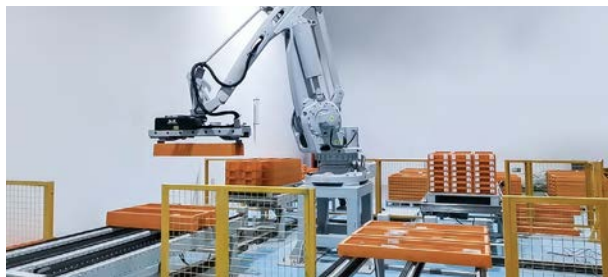
某大型铁路工程企业 视觉引导岩芯盒拆码垛
