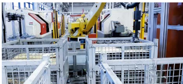
某大型工程机械厂 视觉引导引导轮抓取上料
