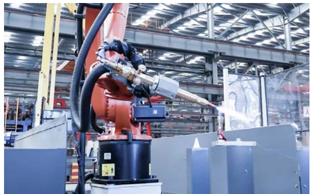
某大型工程机械厂 3D 视觉引导坡口切割
