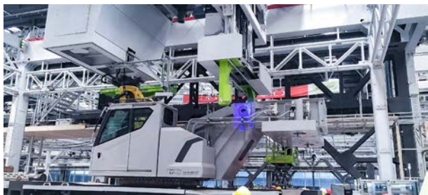
某大型工程机械厂 视觉引导回转支撑拧紧
