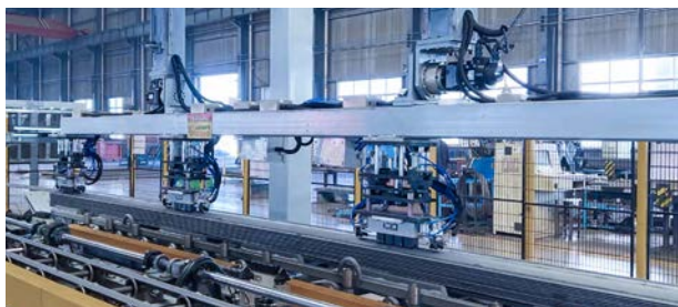
某大型钢铁厂 视觉引导角钢拆垛
