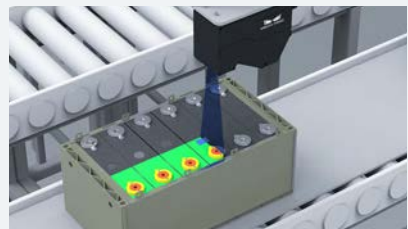
锂电池模组 busbar 焊缝检测
