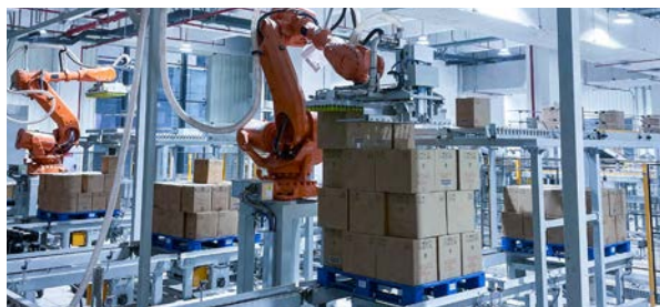
某大型酒厂 视觉引导纸箱拆垛
